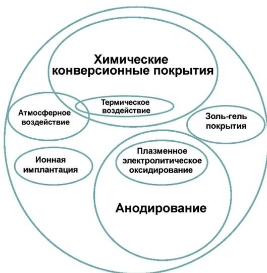
Рис. 3.52. Возможные способы защиты сплавов магния для практического применения в медицине [15]
