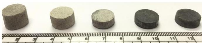
Рисунок 3 – Общий вид образцов матриц, полученных ИПС консолидацией порошков цеолита “Чугуевский” при температурах от 700 до 1100 °С (слева направо шаг 100 °С), содержание цезия ~13.5 масс.%
